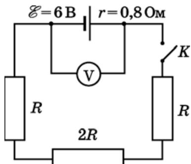
13. На рисунке изображен фрагмент электрической цепи. Учитывая показания приборов (см. выноски), рассчитайте мощность тока на резисторе сопротивлостью  $10\Omega$ .
